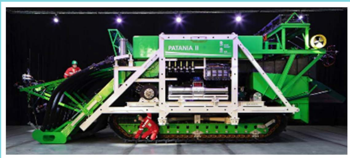
Figure 14 : Patania II : prototype de collecteur industriel de nodules polymétalliques
