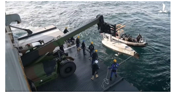
Déploiement de l'USV Magellan de Couach depuis le radier du Tonnerre / Marine Nationale
