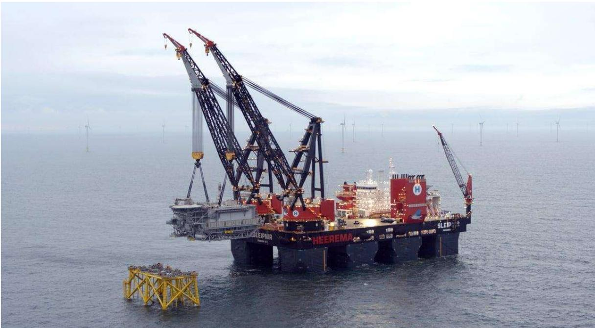
*Semi-Submersible Crane Vessel (source : Heerema)*
