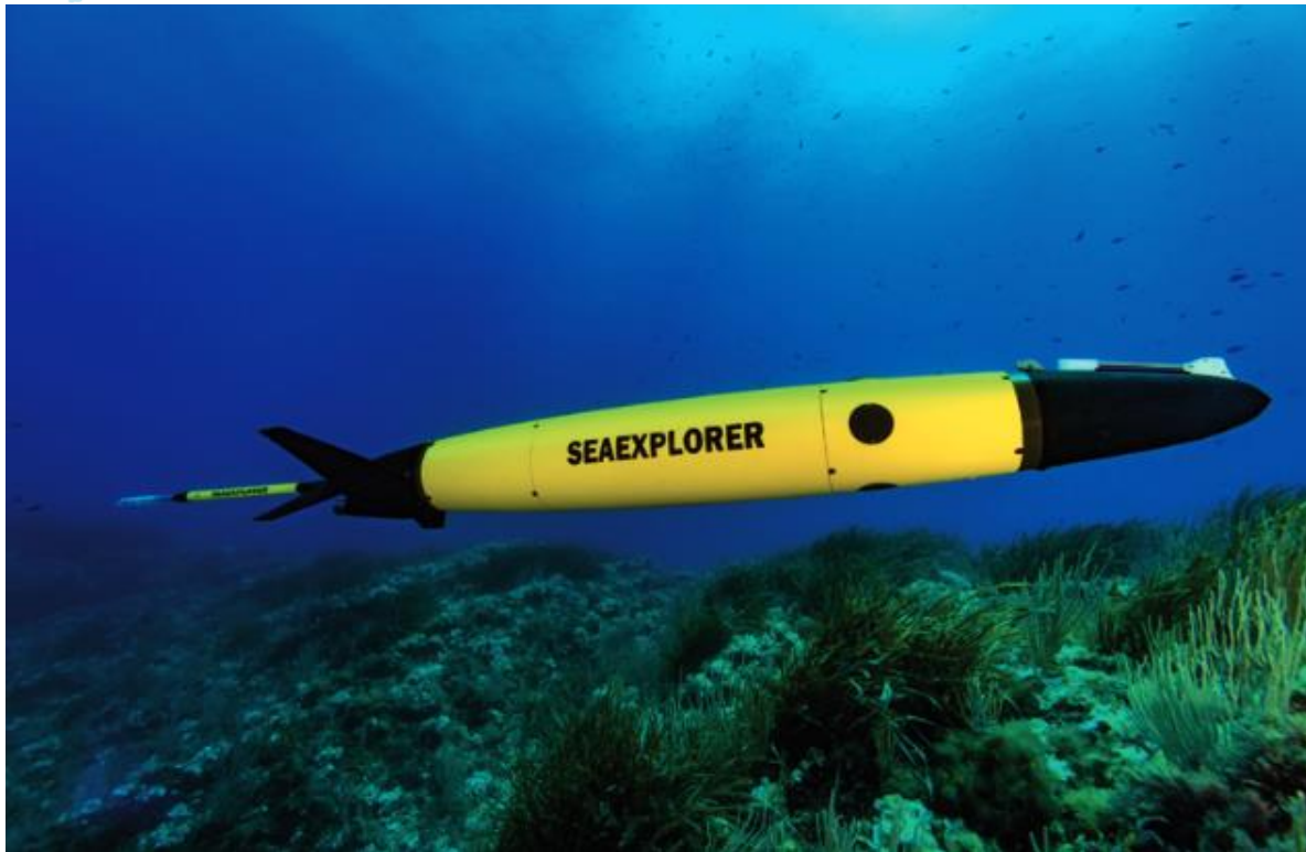
Figure 1. Le glider "Sea Explorer" de l'entreprise ALSEAMAR. Source : Alsearmar-alcen.com
