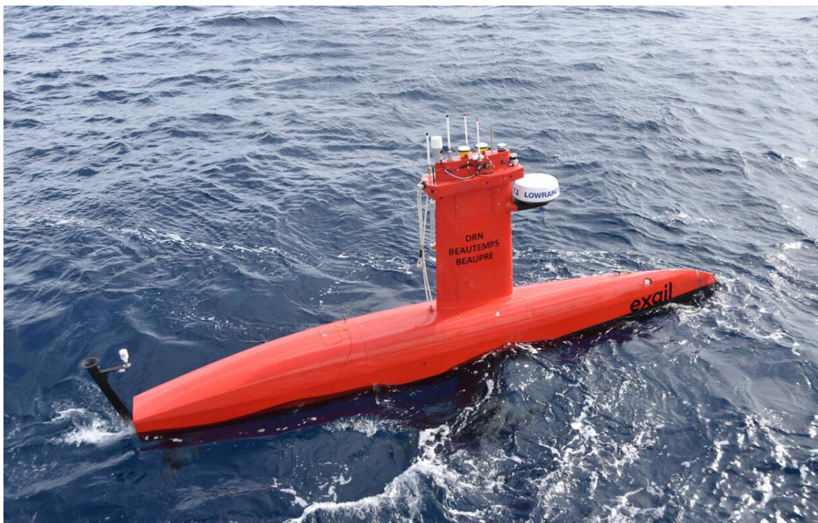
Figure 2. Le drone de surface Drix de l'entreprise française Exail. Photographie tirée du média Le marin Ouest France ©Jean-Marc Tanguy
