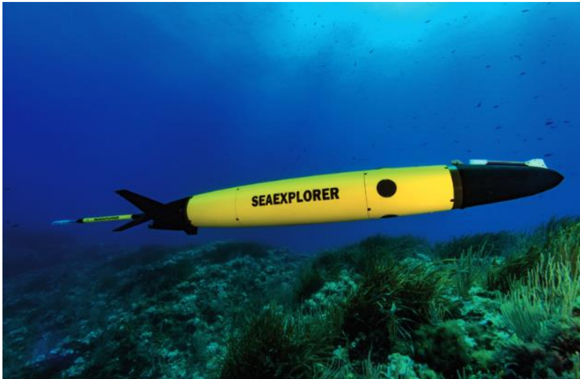
Figure 1. Le glider "Sea Explorer" de l'entreprise ALSEAMAR. Source : Alseamar-alcen.com
