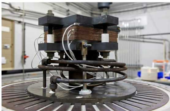
Figure 2 : Cellule d'électrolyseur à haut rendement développé par Genvia
